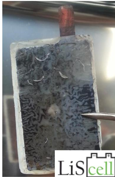
**Si Dünnschichtanode nach ca. 20 Zyklen**
