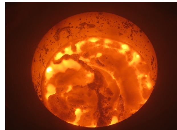
Ausbildung der Schlackeschicht auf im Tiegel erschmolzenem Stahl (beispielhaft)
