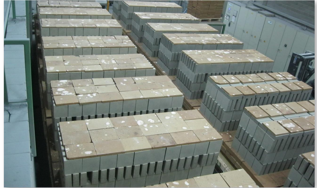
Abgedeckte Tunnelofenwagen, damit ein Ausschuss durch Abtropfungen vermieden werden kann.
