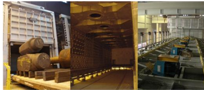
Herdwagenofen mit Zwangsumwälzung (Anlassöfen) Kaltluft - Impulsbrenner
