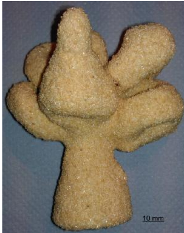
Formschale für den Feinguss von Schmuck
