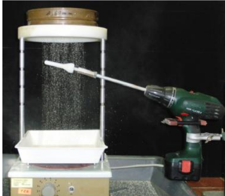
Besandung mittels modifizierter Siebmaschine und Bohrmaschine
