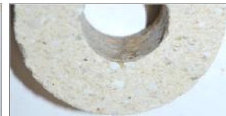
23 \text{Al}_2\text{O}_3 /71 \text{SiO}_2 /3 % Alkali à Verglasung
