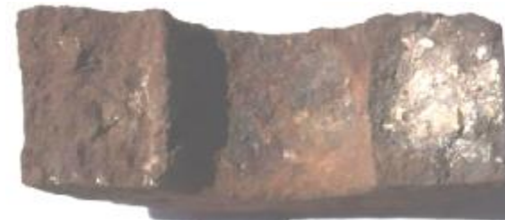
Riss und Querbruch: Tonerde + 4 Ma.-% SiC
