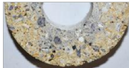
44- \text{Al}_2\text{O}_3 /51 \text{SiO}_2 à Infiltration
