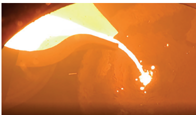
Abbildung : Additiv gefertigte Schmelzdüsen im Stahlguss-Simulator (© TU Bergakademie Freiberg)
