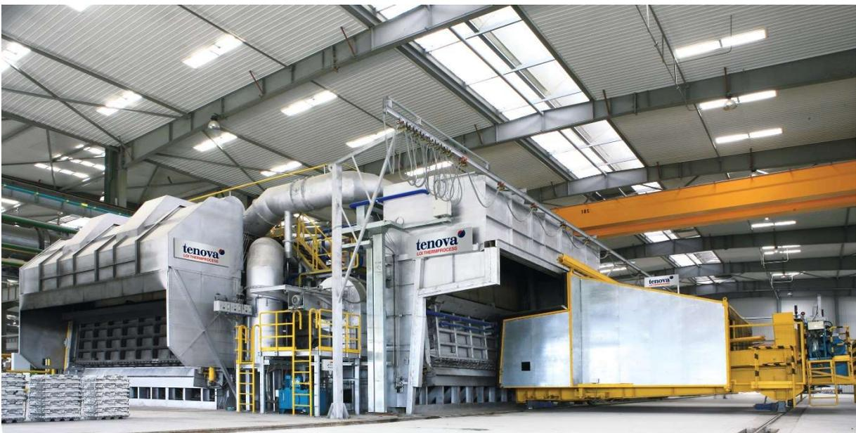
Bild 3: Zweikammer Schmelz- & Recyclingofen TCF® der aktuellen Generation mit Nebenaggregaten
