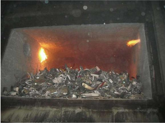
Bild 2: Erste Generation Zweikammer Schmelz- & Recyclingofen TCF® von 1990
