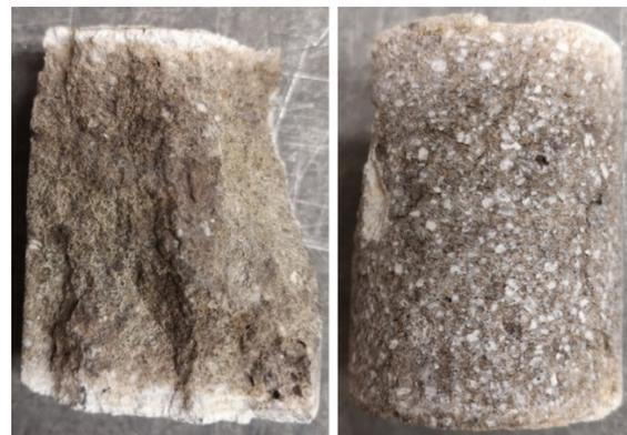
Bild 8: KDF-Proben mit 99 und 117 MPa (Neuzustand: 70-100MPa)
