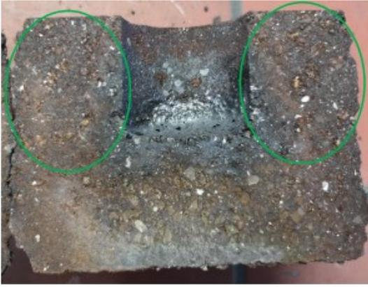
*Bild 14: Mg-Cr (20% Cr<sub>2</sub>O<sub>3</sub>): Schlacke ist vollständig infiltriert*
