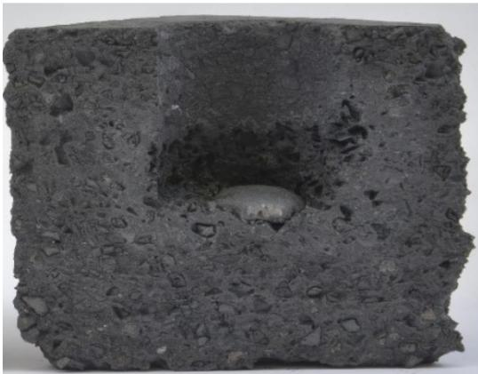
*Bild 15: Al-C-SiC (10%SiC) DRI und Schlacke vollständig infiltriert, Auswaschungen*
