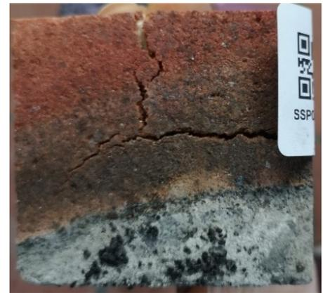
*Bilder 17 und 18: Korundstein mit 99% Al<sub>2</sub>O<sub>3</sub>, vollständig infiltriert, Durchbruch*
