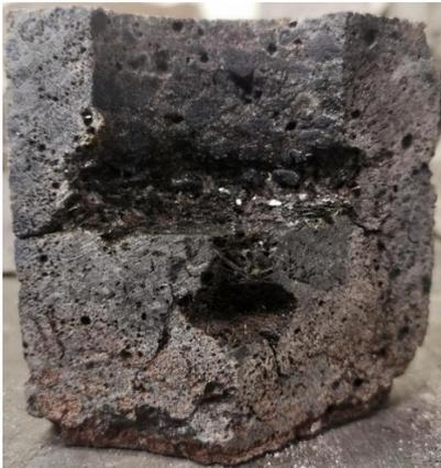
*Bild 21: Fertigbauteil aus Korundbeton für den Einsatz im Hochofen*
